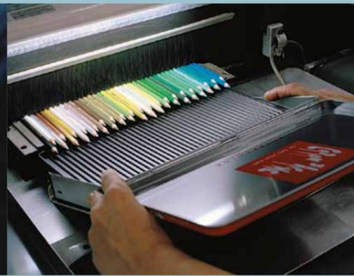
Die Farbstifte werden in mehreren Schichten lackiert. Dazu verwenden wir ausschliesslich Lacke auf Wasserbasis.
